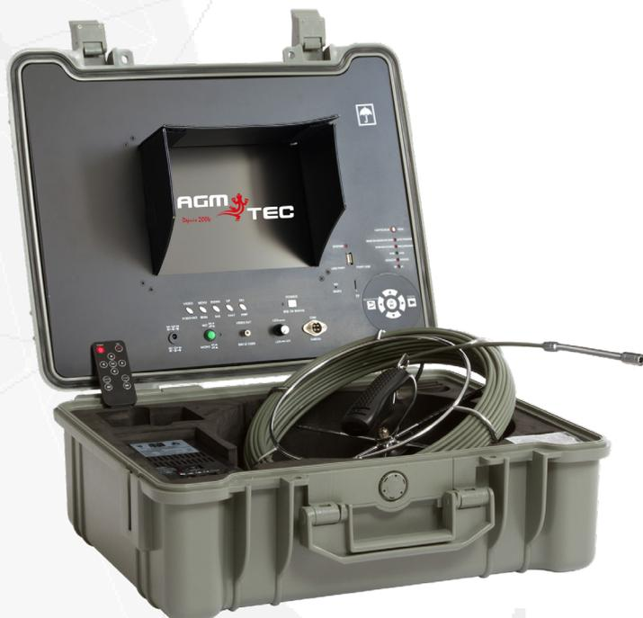
Utilizável por um único operador, a câmara de inspeção Tubicam® R14 é ideal para visualizar pequenas canalizações e tubos de piscina, graças à sua cabeça de Ø14 mm, em diâmetros que variam de Ø20 mm a Ø70 mm, até 20 metros de distância.
