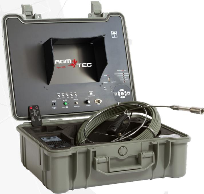
A Tubicam® R23 é a câmara a mais adequada para inspecionar redes domésticas e de esgoto. É a ferramenta ideal para visualizar tubulações com diâmetro de Ø30 mm a Ø200 mm, em um comprimento máximo de 40 metros.
